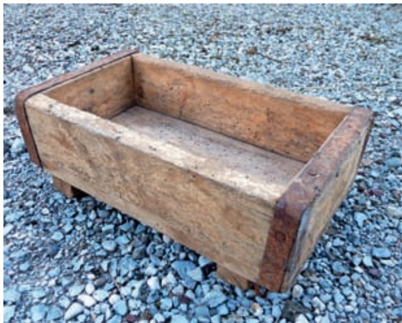
Model za izdelavo opek je ojačan s kovinskimi vezmi.
