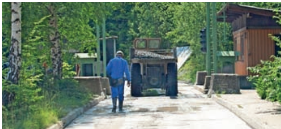
Slika 2: Radiometrična vrata na platoju P-11 v RUŽV, meritev sevanja gama tovora v kesonu jamskega kamiona
