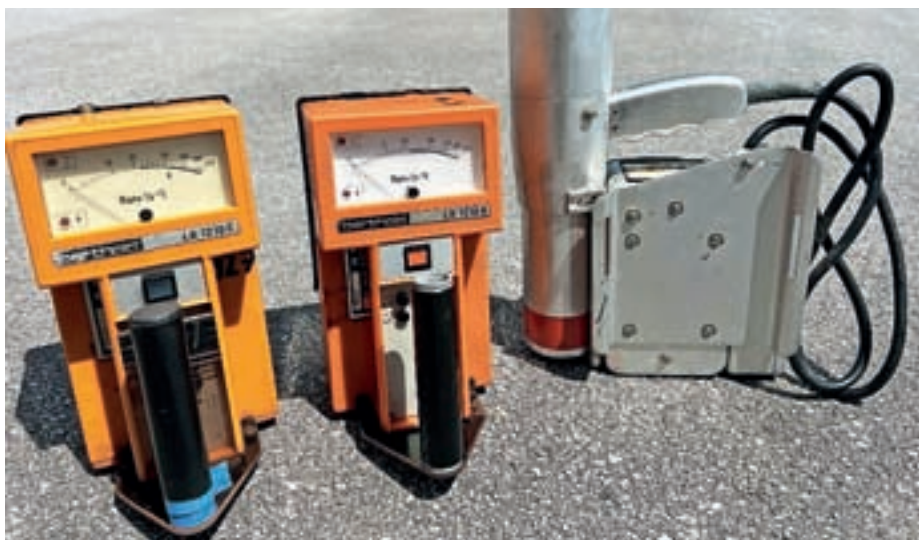
Slika 1: Instrumenti za meritve sevanja alfa (levo) in sevanje beta (sredina) ter sevanja gama (desno), last RUŽV
